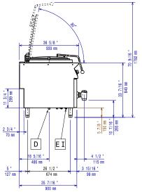
CWI1 = Kaltwasserzulauf D = Ablauf EI = Elektroanschluss HWI = Warmwasserzulauf
